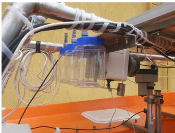
Фигура 2: Устройство (3 бутилки) за водни проби
