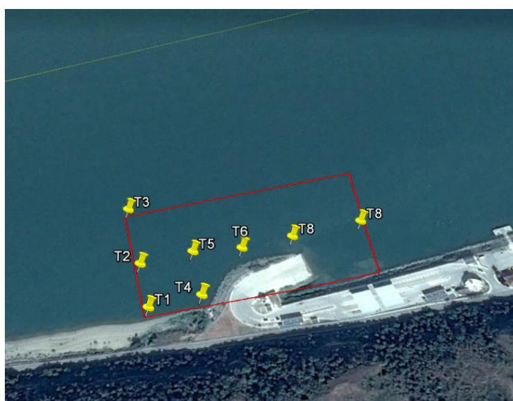
Фигура 4: Примерно местоположение на точки за измерване на скорости или мътност около съоръжение в река
