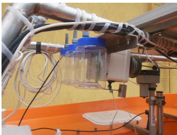
Фигура 2: Устройство (3 бутилки) за водни проби
