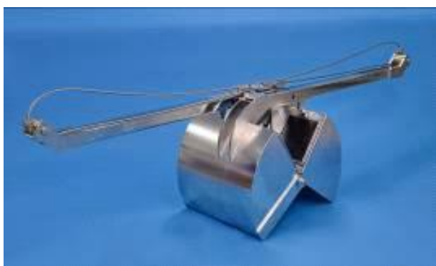
Фигура 3: Устройство за пробонабиране на наноси (дънни проби)
